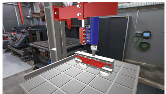
Visualisierung des Entkernfortschritts eines eingegossenen Kerns in einem Gussteil
