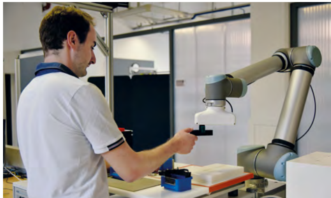
Mensch und Roboter arbeiten in einem gemeinsamen Arbeitsraum an einer Montageaufgabe – in diesem Fall reicht der Roboter dem Menschen ein Bauteil.
