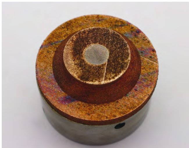
Multimaterial-Werkzeugeinsatz aus Kupfer-Chrom-Zirkonium und Werkzeugstahl
