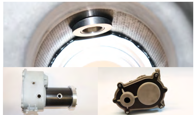
Getriebegehäuse mit erhöhter Steifigkeit und 20 Prozent weniger Gewicht: Pfiffige wie serientaugliche CFK/Aluminiumguss-Hybridlösungen des Fraunhofer IGCV für den Maschinenbau
